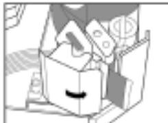
Осторожно закройте печатающую головку — должен защелкнуться фиксатор.
