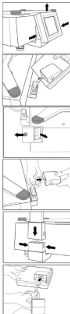
Нажмите на кнопки фиксаторов, расположенных по бокам основания дополнительного индикатора, и отсоедините индикатор от основания.
