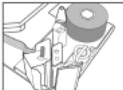
Установите рулон в соответствии со схемой, нанесенной на основании печатающего механизма. Не забудьте закрепить подложку на приемной бобине.
