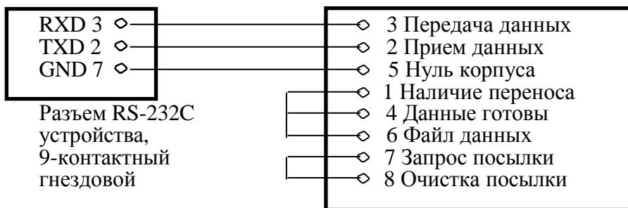
Схема соединения с выносным индикатором:
