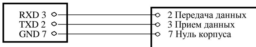
Схема соединения с принтером серии СР-7000:
