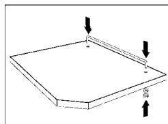
Извлеките из пакета с принадлежностями гайки, шайбы и защитное ограждение весовой крышки. Установите ограждение в отверстия весовой крышки и вручную закрепите его с помощью шайб и гаек. Установите весовую крышку на весы.
