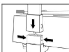
Нажмите на кнопки фиксаторов, расположенных по бокам основания дополнительного индикатора. Установите стойку на основание индикатора.
