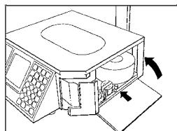
Задвиньте печатающий механизм в корпус весов. Закройте пластиковую дверцу.
