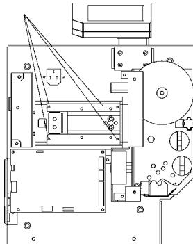
В случае замены датчика веса необходимо проверить и заново выставить ограничители перегрузки по методике, описанной ниже. Защита от перегрузки осуществляется с помощью установочных винтов нижней крестовой рамы. В случае перегрузки эти винты упираются в ограничители, установленные в основании весов.
