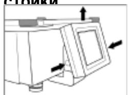
Нажмите на кнопки фиксаторов, расположенных по бокам основания дополнительного индикатора. Отсоедините индикатор от основания.
