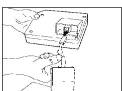
Присоедините кабель, выходящий из верхнего конца стойки, к разъему дополнительного индикатора.
