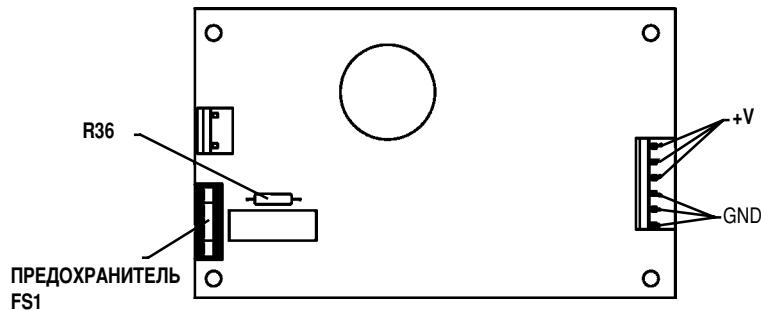
Если напряжение на выходе блока питания отсутствует, проверьте входное переменное напряжение 120 В. Подключите вольтметр между нижним контактом предохранителя FS1 и правым выводом резистора R36. Если входное переменное напряжение в норме, а выходное напряжение +24 В отсутствует — замените блок питания.
