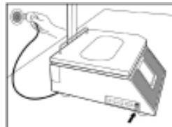
Извлеките сетевой кабель из упаковочной коробки. Подключите сетевой кабель к разъему, расположенному в нижней части весов. (Если весы хранились или транспортировались при отрицательных температурах, перед включением в сеть необходимо дать им прогреться до комнатной температуры.) Подключите сетевой кабель к розетке сети переменного тока. Установите сетевой выключатель в положение ON. Перед началом настройки весы должны прогреться не менее 30 минут.
