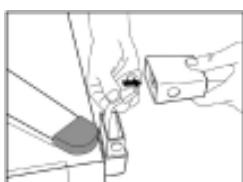
Присоедините кабель, выходящий из основания дополнительного индикатора, к разъему на нижнем конце стойки.
