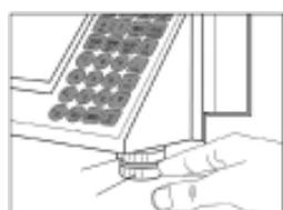
С помощью регулируемых опор выровняйте весы, чтобы пузырек располагался точно по центру уровня. Зафиксируйте опоры в установленном положении с помощью стопорных гаек.
