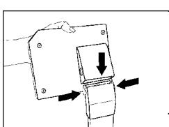
Нажмите на кнопки фиксаторов, расположенных по бокам верхней части стойки. Установите на стойку дополнительный индикатор.
