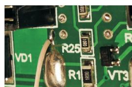
9. Припаять к верхней части перерезанного проводника отрезок провода.
