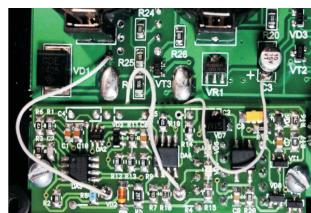
12. Распаять 3 провода. Правый провод ("+" питания) припивается к плюсу С3. Закрепить плату двумя саморезами.
