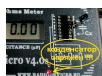
16. Подключаем конденсатор к панельке. Должен засветиться КРАСНЫЙ светодиод. Показания дисплея - “---- 0.00”
