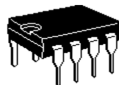
Корпус DIP-8 Типономиналы: КР1033EY15А,Б КР1033EY16А,Б
